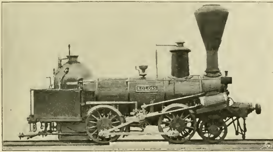
Abb. 282. Güterzug-Locomotive der Nordbahn. [1844.]
